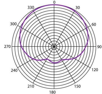
Die RC 35 Kapsel enthält das 1,5" grosse dynamische Element des PR 35, das einen breiten Frequenzgang, natürliche Stimmartikulation und eine hohe Rückwärtsdämpfung von den Seiten und von hinten hat.
